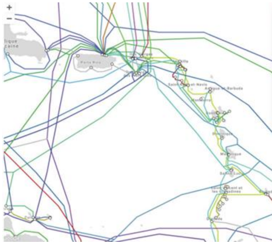
Desserte en câbles optiques sous-marins de la plaque Caraïbes
